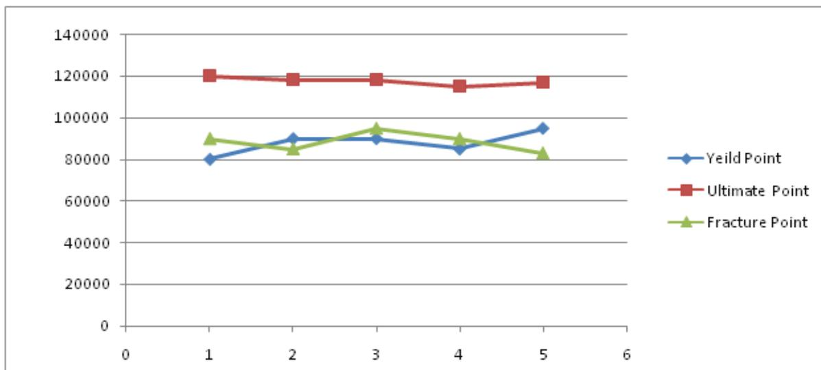
Figure 8 Strength (N/mm<sup>2</sup>) Vs Temp. (°C)
