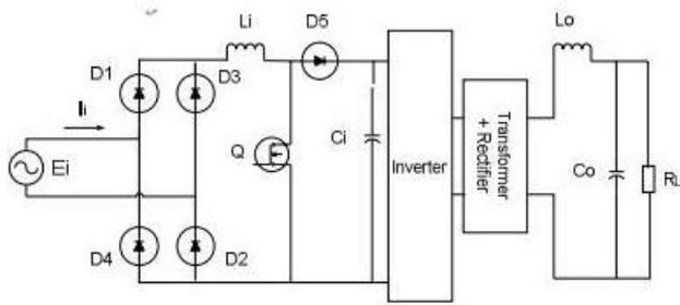
Fig. 4 CSF SMR Converter
